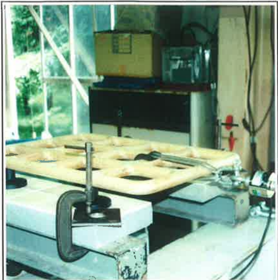
写真-1(j) 試験状況：鉛直P1(躯体:コンクリート)
