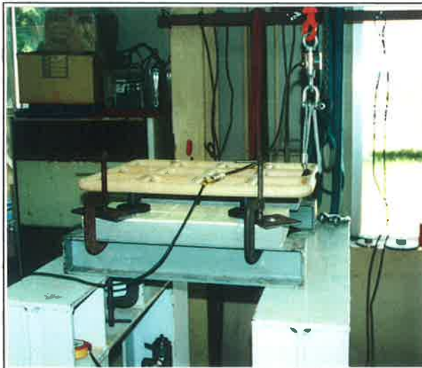
写真-1(h) 試験状況：水平P3 (躯体:コンクリート)
