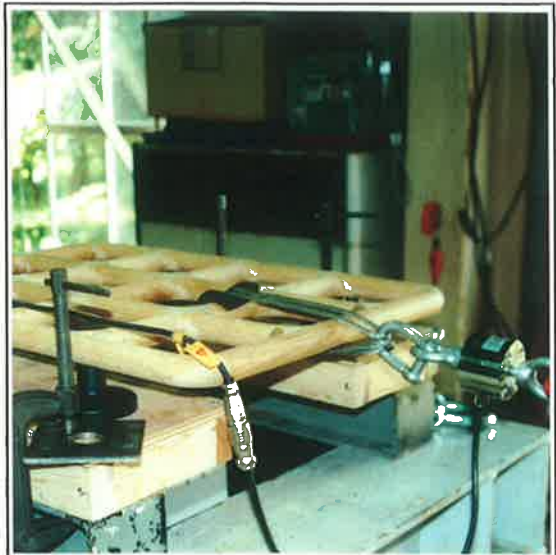
写真-1(d) 試験状況：鉛直P1 (躯体:合板)
