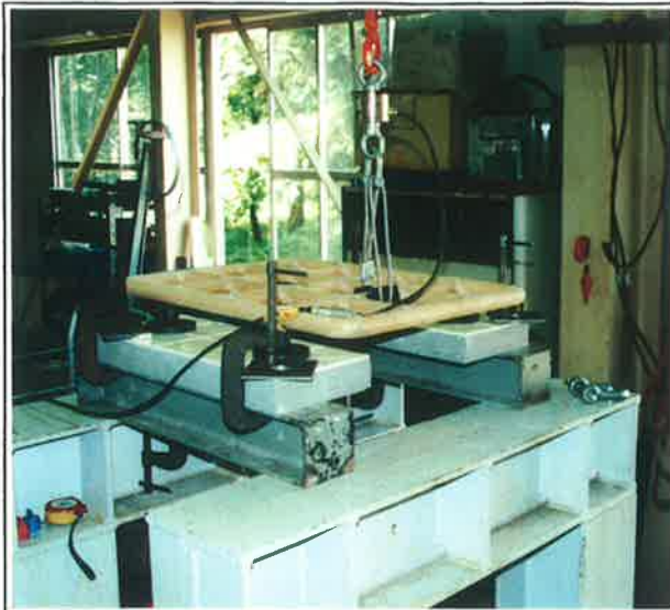
写真-1(g) 試験状況：水平P2 (躯体:コンクリート)
